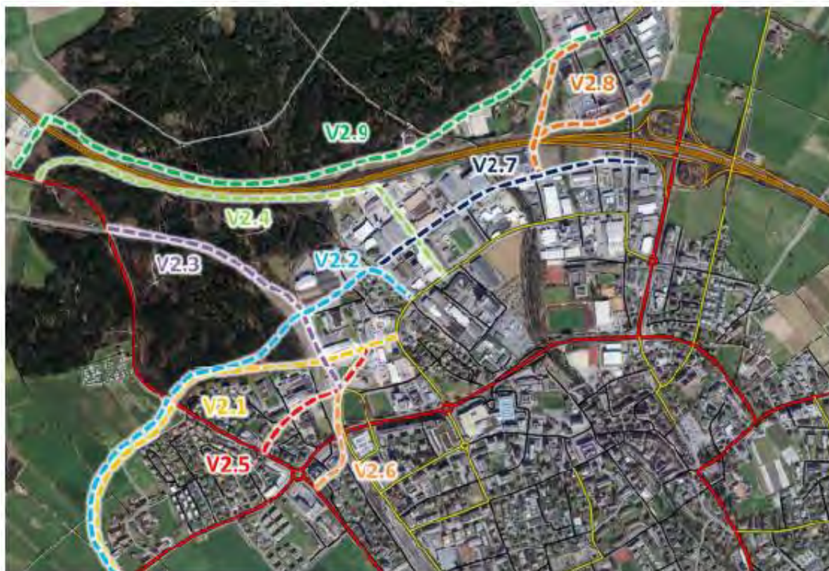
Abbildung 32: Mögliche Netzergänzungen im Industriegebiet (Quelle: [9])
