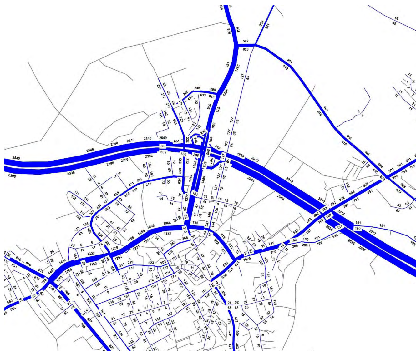
Abbildung 20: Belastungsplot ASP 2040, GVM Luzern [Mfz/h] (Grossformatiger Plot in Anhang 2)
