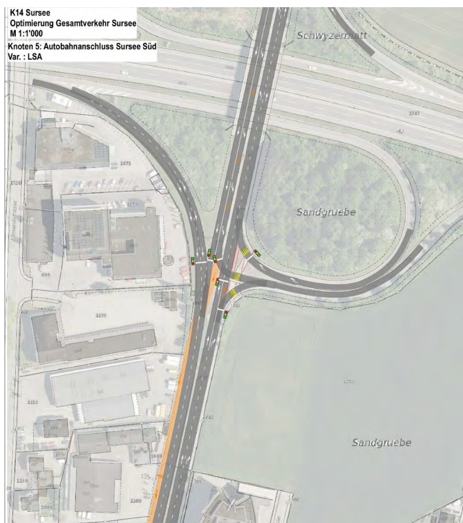
Abbildung 48: Knotenskizze Autobahnanschluss Süd
