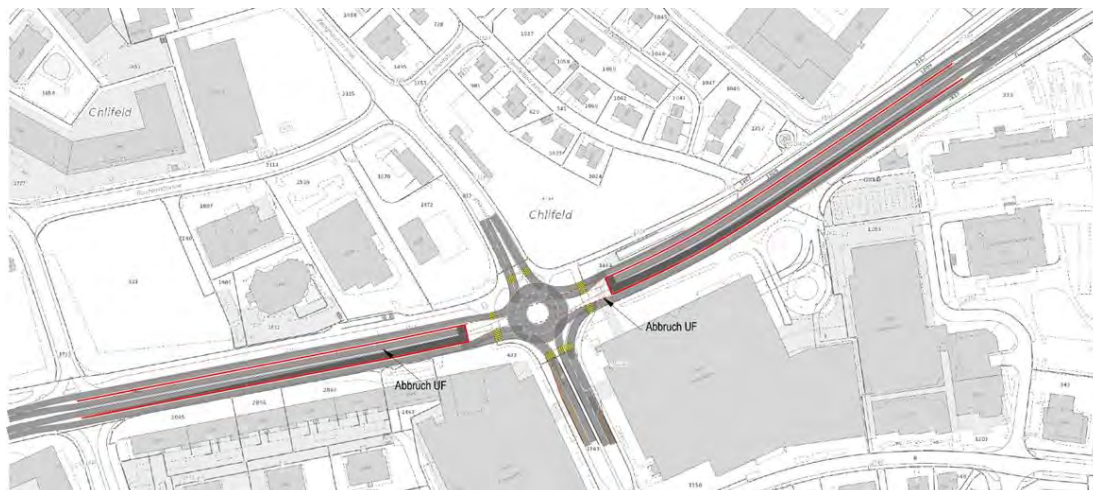
Abbildung 68: Schemaskizze Unterführung Kreislauf Bifang
