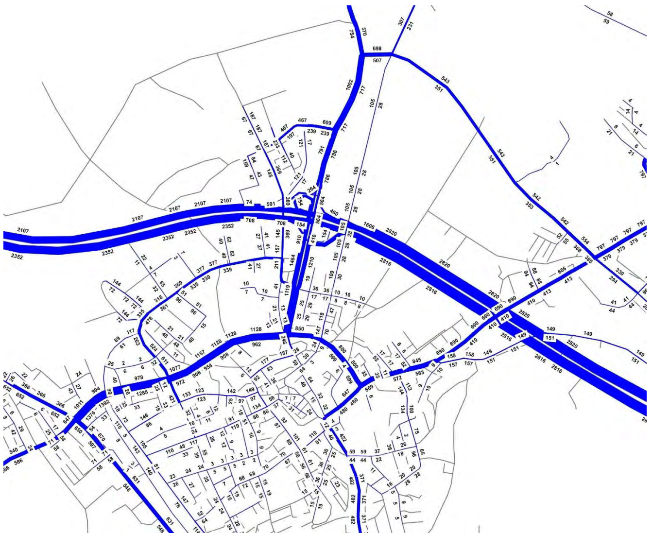
Abbildung 19: Belastungsplot MSP 2040, GVM Luzern [Mfz/h] (Grossformatiger Plot in Anhang 2)
